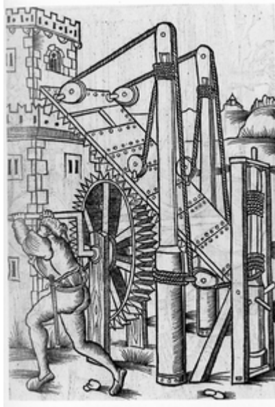
Modello di ponte elevabile dal De re militari di Vegetio, Erfurt 1512-'13
